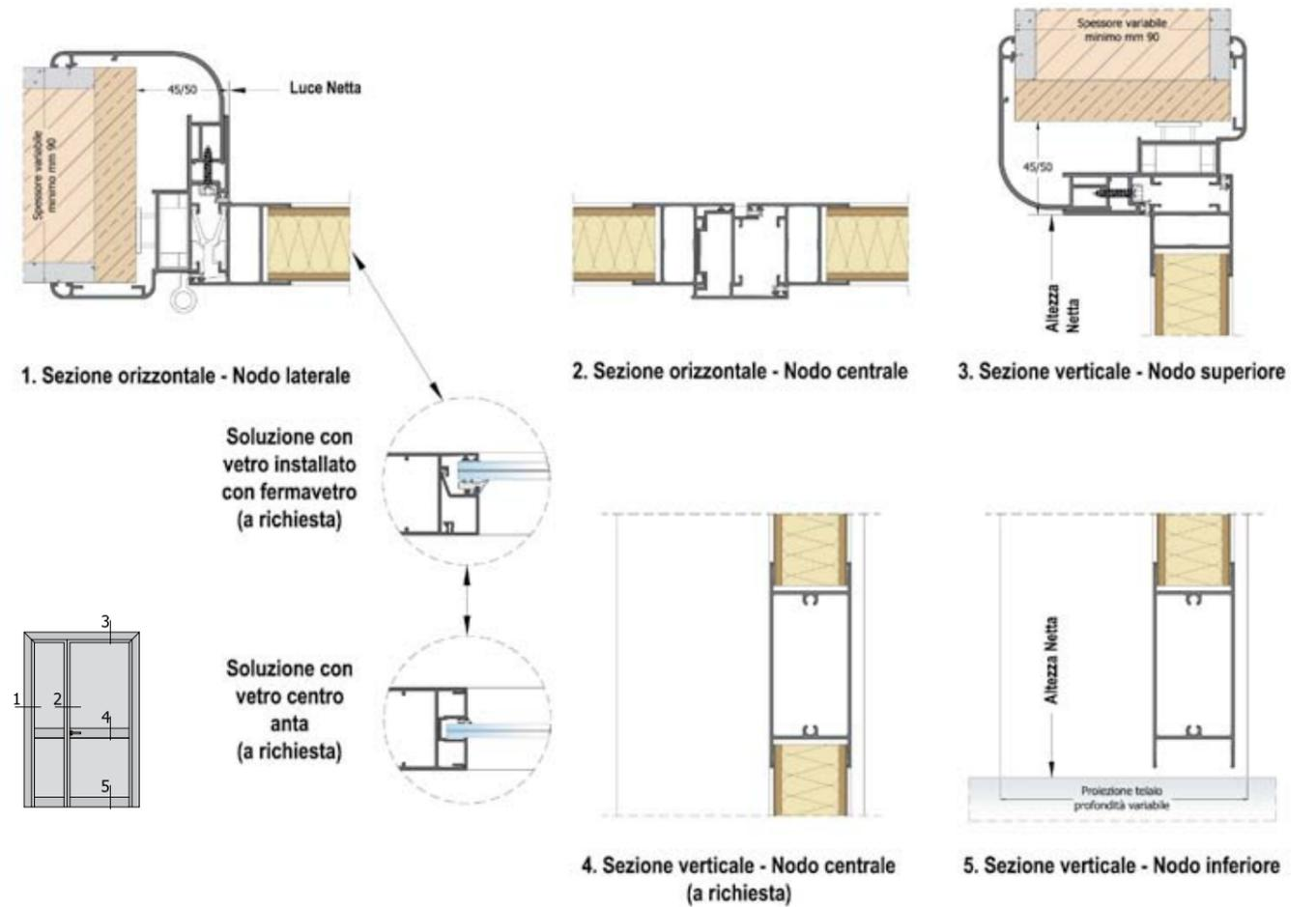
**1 Telaio telescopico** in alluminio a due elementi posto a rivestimento dell'eventuale controtelaio in legno o della muratura, adatto a spessori convenzionali variabili da mm 90 a 150 o superiori con appositi distanziatori. Dotato di guarnizione di battuta esterna dell'anta in EPDM colore nero e di regolatori di compensazione su tre lati per una agevole installazione. Profilo base arrotondato o squadrato su richiesta.
